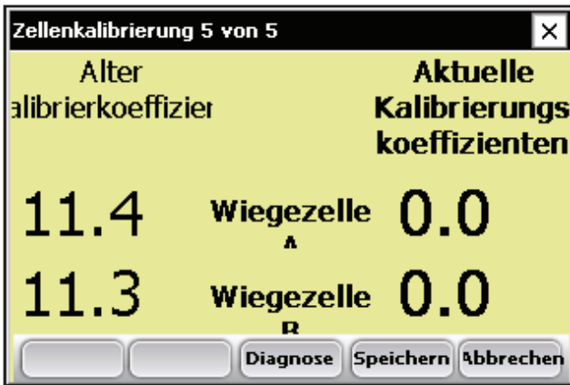
Abbildung 3-9: Alte und aktuelle Kalibrierungskoeffizienten werden angezeigt.
