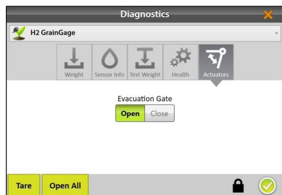
Utilisez l'écran Diagnostosics des actuateurs pour tester manuellement l'actuateur qui contrôle la porte d'évacuation du GrainGage. Pour plus d'informations au sujet des actuateurs, voir **2.3.2 Configurer l'actuateur à la page 25**.
