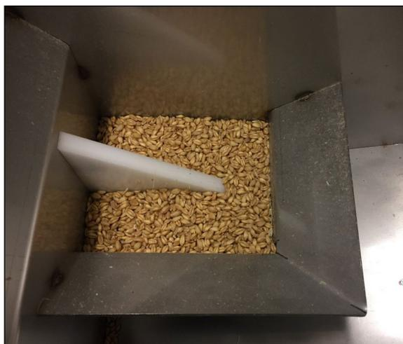
*Remarque : HarvestMaster recommande que la même personne verse le grain directement sur la lame d'humidité et de la même manière à chaque fois. Cette photo présente la quantité minimale de grain nécessaire pour couvrir la lame d'humidité.*
