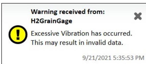
Lorsque vous utilisez le H2 Stationary GrainGage, vous pourriez voir un message d'avertissement concernant des vibrations excessives. Cela se produit lorsque le GrainGage n'est pas posé sur un sol ferme.
