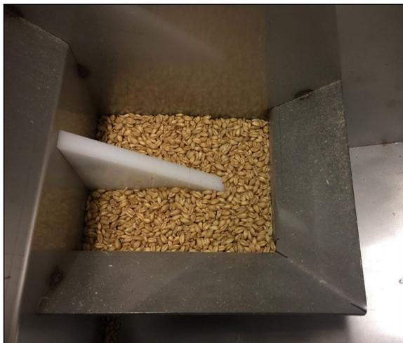
12. Versez un échantillon de grain dans le GrainGage directement sur la lame d'humidité.
