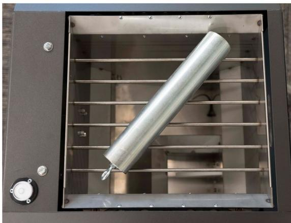
2. Placez le poids de calibration en diagonale en travers de la grille.
