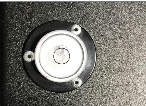
5. Utilisez le niveau à bulle sur le dessus du GrainGage pour vérifier que le GrainGage est à niveau et stable.
