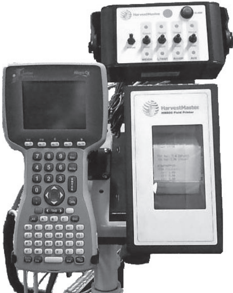
Figure D-1 : Vue frontale des composants du HM-800
